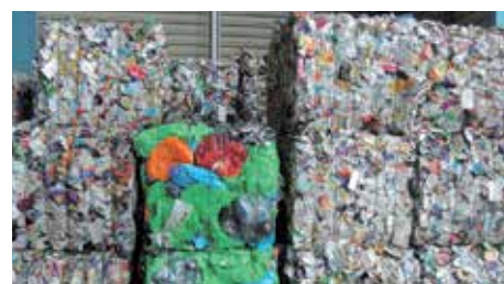
Les déchets sont compressés en balles de matériaux homogènes
